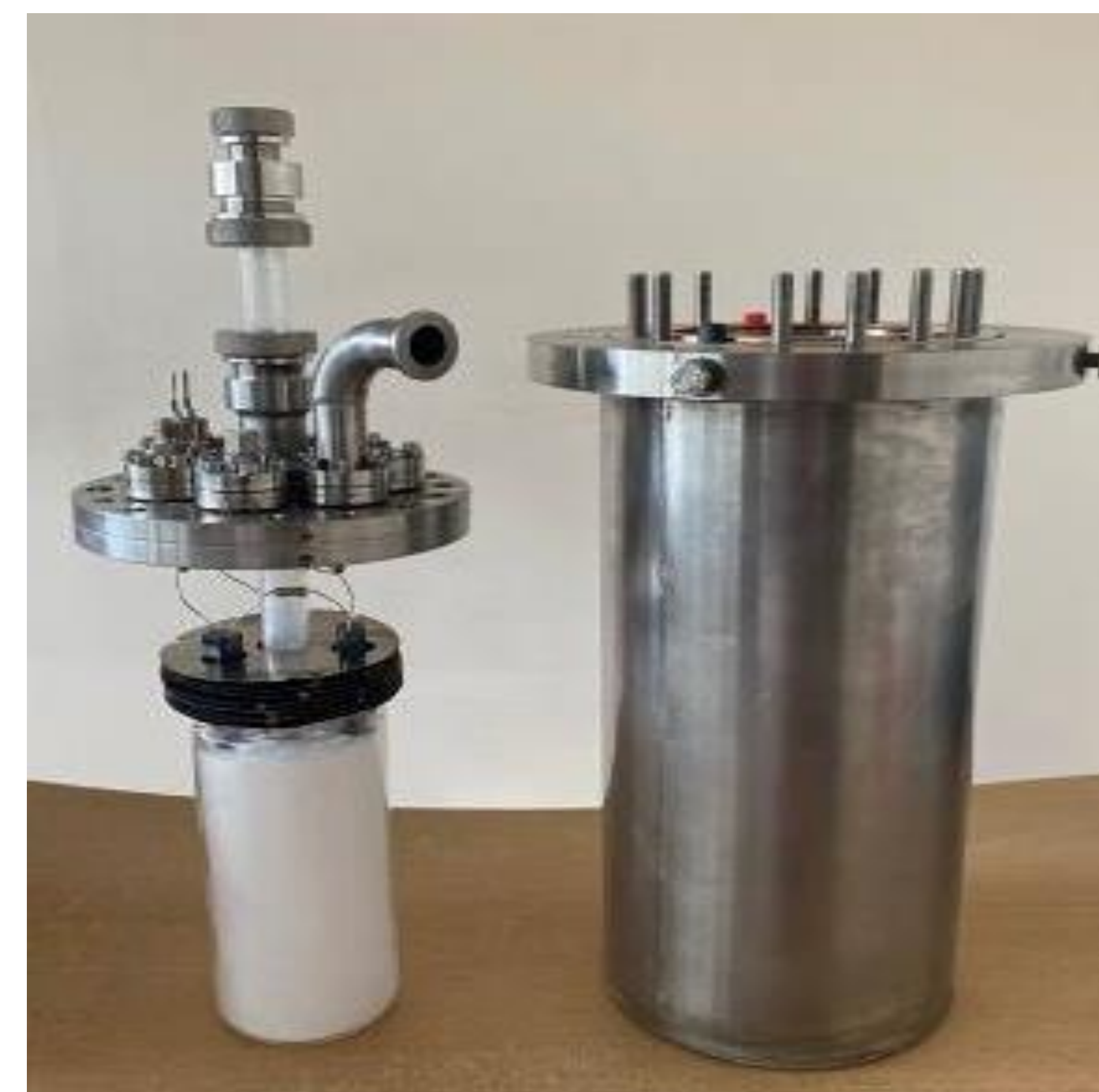
Rys. 1 Reaktor fuzyjny wykorzystujący nanoproszki jako katalizator reakcji jądrowych
